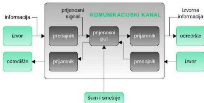
Slika 1.2. Blokovska shema poludvosmjernog komunikacijskog sustava
