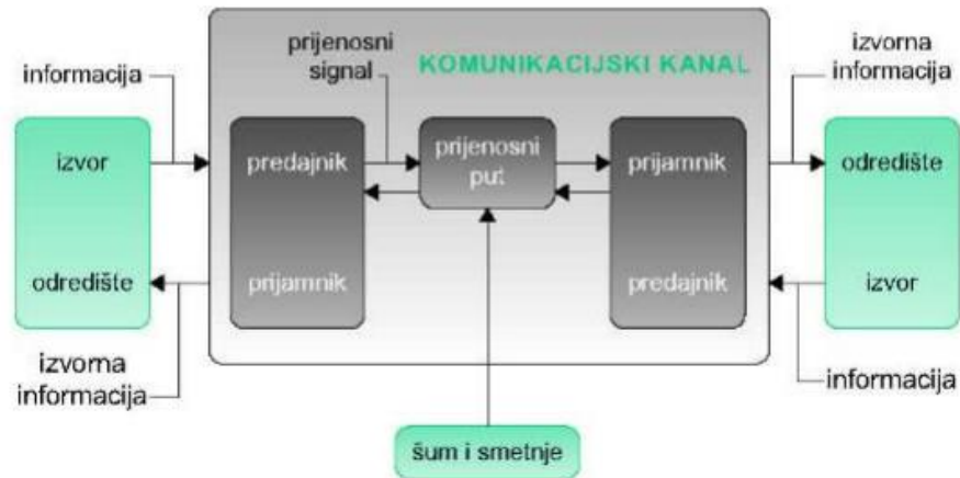
Slika 1.3. Blokvska shema dvosmjernog komunikacijskog sustava
